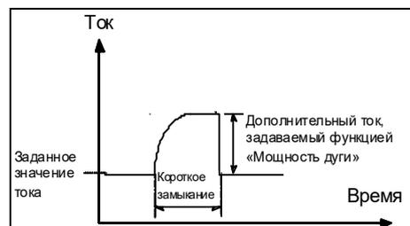
Значение мощности дуги можно регулировать в диапазоне от 0 до 100% заданного сварочного тока.
