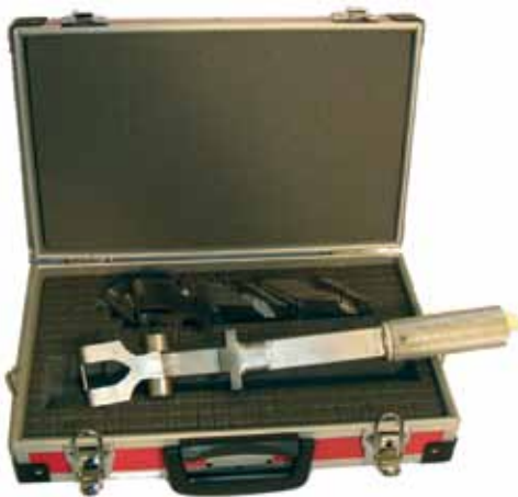
TackClamp box Dimensioner (lxbxh): 41x26x10 cm Vikt: 5,0 kg För rör: Ø60-600 mm Antal länkar som åtgår: Rördiam. (cm) / 2 Artikelnr. 31-TC600
